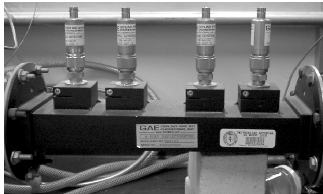
Fig. 5. Reflectómetro con cuatro detectores (arriba) colocado como parte de la guía de onda.
